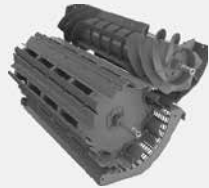
Молотильный барабан 600 мм как в сериях LEXION C7
