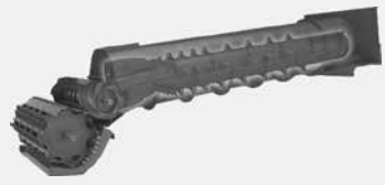
Ротор для сепарации остаточного зерна 570 мм как в серии TUCANO 500
