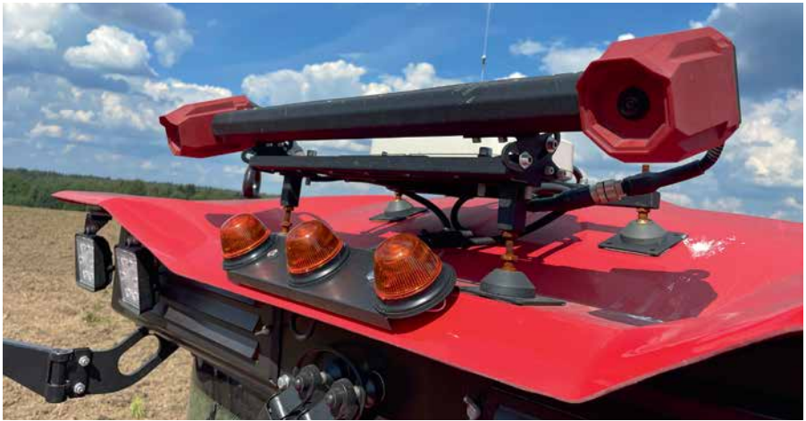
Цветная стереовидеокамера, модули высокоточной навигации, связи GPS и радио
