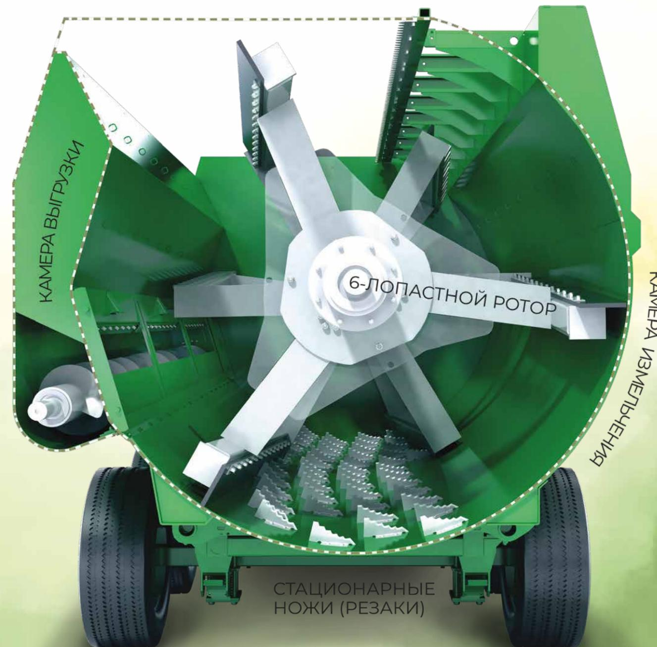
**Кормосмеситель KEENAN** — это двухкамерная система, состоящая из камеры смешивания и измельчения и камеры раздачи и выгрузки. Только зеленая машина KEENAN с 6-лопастным ротором и патентованной системой стационарных ножей может производить моноорм MechFiber — легкую, вспушенную смесь с нужной колючестью. Благодаря инновационной конструкции остатки корма не залеживаются на дне смесителя, весь моноорм выгружается.
