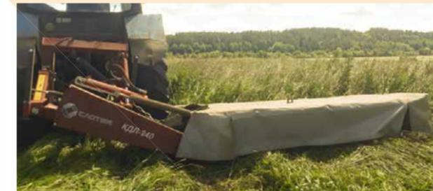
**Косилки дисковые с шириной захвата 2,5 и 2,9 метров**
