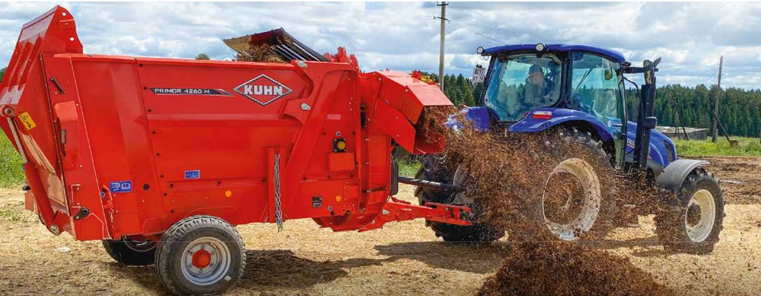
Измельчитель-выдуватель соломы KUHN Primor 4260M производство Франция самозагрузка, вместимость 2 рулона (2 тюка) регулируемая длина резки от 4 см управляемый выдув до 18 м
