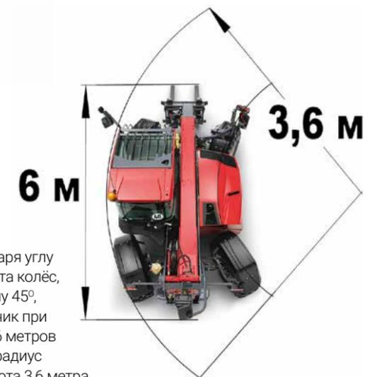
Благодаря углу поворота колёс, равному 45°, погрузчик при длине 6 метров имеет радиус разворота 3,6 метра
