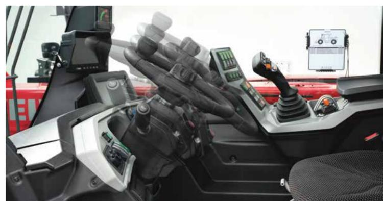
Регулировка руля в 2-х плоскостях, регулируемое сидение и подлокотник позволяют настроить рабочее место под оператора любой комплектности
