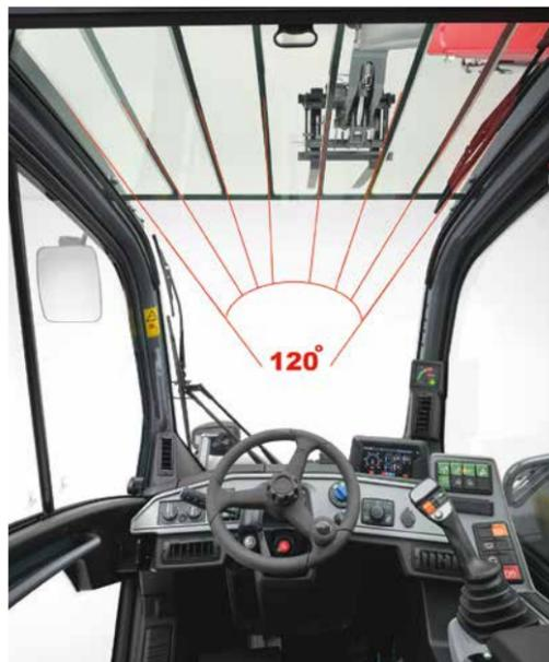
Панорамное лобовое стекло, а также решетка с веерной конструкцией позволяет безопасно выполнять высотные работы
