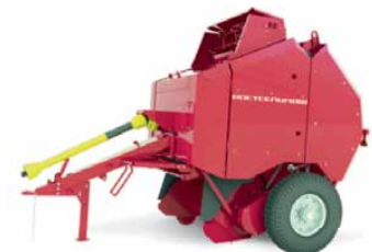
Пресс-подборщик рулонный PELIKAN 1200 ширина захвата 1,5 м производительность до 10 т/ч
