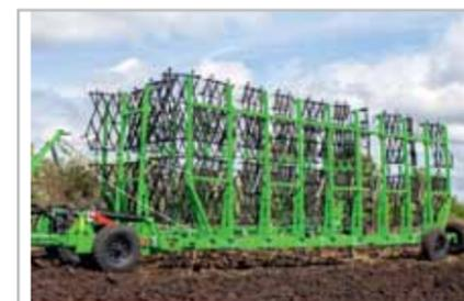
Бороны гидрофицированные из высокопрочной стали 0.9Г2С ГОСТ. Ширина захвата - от 12 до 27 м и производительность - от 14,4 до 32,4 га/ч. Работают с тракторами от 120 до 450 л.с.
