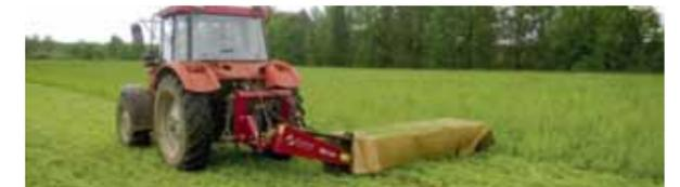
**Косилки дисковые 2,5 и 2,9 метров ширина захвата**
