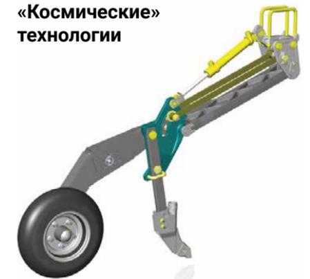
Запатентованная параллелограммная конструкция анкерных сошников PARALINK сохраняет угол атаки сошника в почве при копировании контура поля, гарантируя заделку семян точно на заданную глубину посева. А широкий выбор рабочих органов и прикапывающих колес позволяет сохранять отличное качество в любых почвенных условиях — после вспашки, дискования, культивации, по стерне и т.п.
