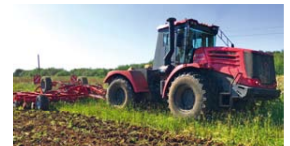
Адаптация Хорш Joker 6HD для работы с тракторами Кировец К744 РЗ
