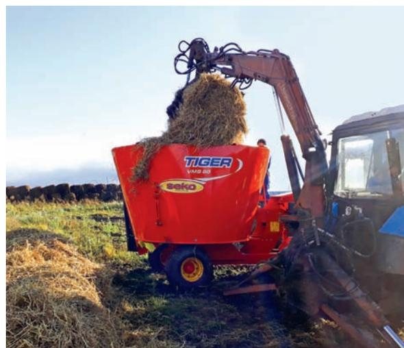
**При желании массу можно измельчать до 3-4 см** без привлечения дополнительных резчиков рулонов. Система резки и смешивания состоит из прочных вертикальных шнеков особой конструкции, укомплектованных 10 специальными ножами. А благодаря двухскоростному редуктору, выгрузка корма происходит равномерно. По заказу миксер может комплектоваться выгрузным конвейером.
