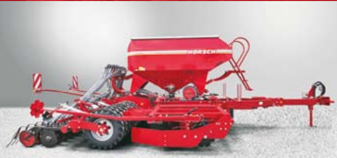
Посевной комплекс Horsch Pronto DC ширина захвата от 4 до 9 м предпосевная комбинация дисков, дисковые сошники Turbo Disc
