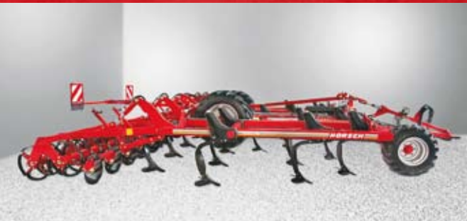
Стерневой культиватор Horsch Terrano FM ширина захвата от 5 до 12 м четыре ряда лап MulchMix на стойках TerraGrip
