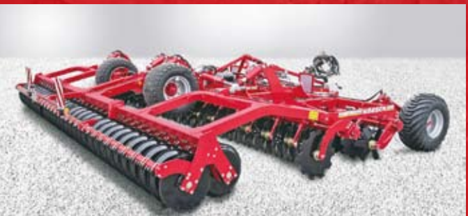
Дисковая борона Horsch Joker ширина захвата от 3 до 12 м двухрядная система дисков DiscSistem, варианты катков
