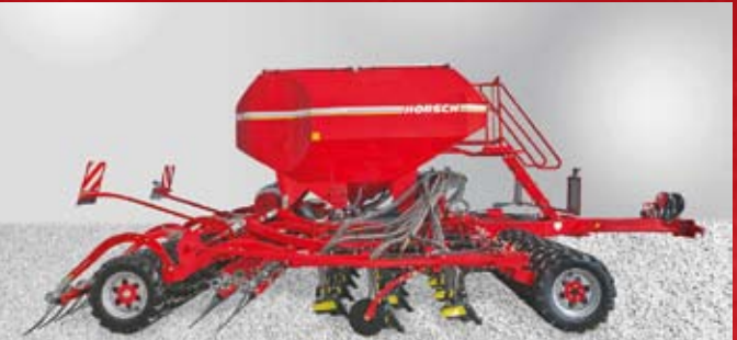
Посевной комплекс Horsch Sprinter ST (SW) ширина захвата от 4 до 12 м двухпотоковые анкерные сошники Andersona
