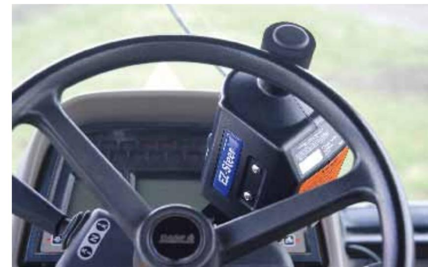
Системы автопилота и подруливающие устройства повышают точность обработки до 2 см
