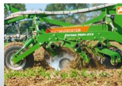
Батарея дисков, оснащенная вырезными дисками диаметром 660 мм. Угол установки 22° передней и 17° задней батареи дисков обеспечивает агрессивный режим работы и интенсивное смешивание.
