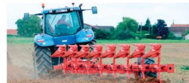
**Оборотный полунавесной плуг на опорном колесе
