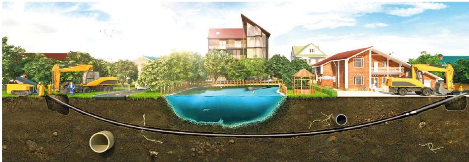
С помощью установки горизонтального направленного бурения можно проложить трубы под рекой,
