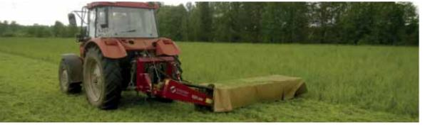
**Косилки дисковые 2,5 и 2,9 метров ширина захвата**
