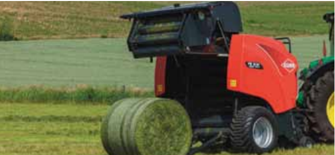
Рулонный пресс-подборщик с фиксированной камерой Kuhn FB 3130 диаметр/ширина камеры прессования, см – 122/125 ширина подборщика – 2,3 м, измельчитель Opticut
