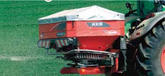
Навесной распределитель минеральных удобрений Kuhn Axis 20.2 ёмкость бункера – 1400 л. (3200 л. с надставками) рабочая ширина внесения удобрений от 12 до 36 м
