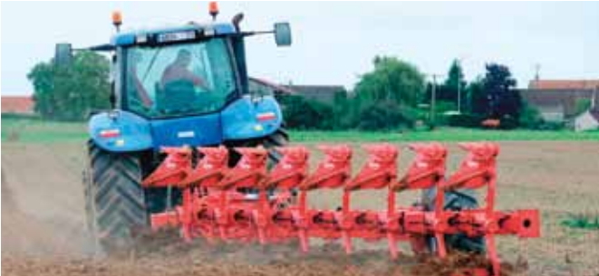
Оборотный полунавесной плуг на опорном колесе Kuhn Multi Leader 8 количество корпусов – 8, ширина захвата корпуса – 35–50 см механическая или гидравлическая защита корпусов
