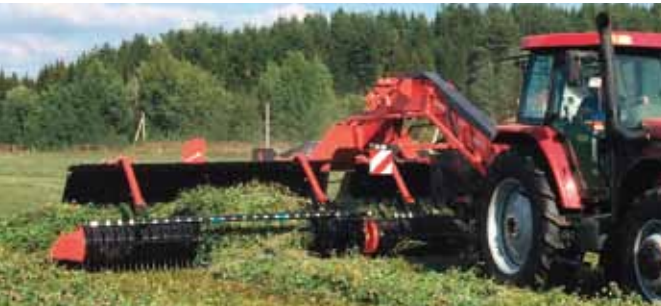
Ленточный валкообразователь-группировщик Kuhn Merge Maxx 902 ширина захвата – 9,1 м, боковой или центральный валок возможность перегруппировки и оборачивания валка
