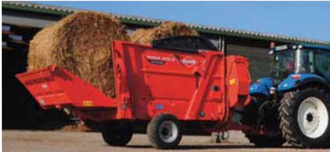
Измельчитель-раздатчик рулонов и тюков Kuhn Primor 4260 вместимость – 4,2 куб.м., изменяемая длина резки расстояние выдува через поворотный раструб до 18 м
