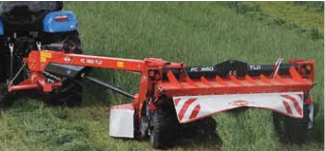
Прицепная дисковая косилка-плющилка Kuhn FC 3160 ширина захвата – 3,10 м, боковой или центральный брус пальцевый или вальцевый плющильный аппарат
