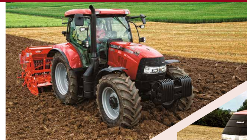
CASE MAXXUM 140 (Англия) Мощность 140 л.с. Трансмиссия Semi Power Shift 16x16 Гидросистема – 113 л/мин. Мощность на BOM – 120 л.с.
