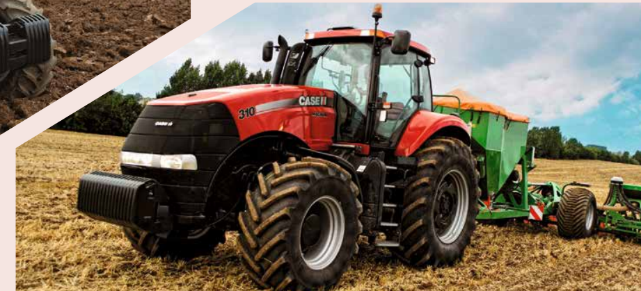
CASE MAGNUM 310 (США) Мощность 311 – 357 л.с. Трансмиссия Full Power Shift 18x6 Гидросистема – 282 л/мин. Мощность на BOM – 265 л.с.
