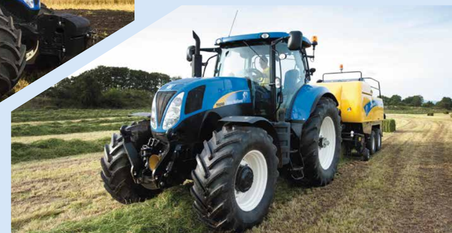
New Holland T6090 (производство Англия) Мощность 168/198 л.с. Трансмиссия Range Command 18Fx4R, 40 км/ч Гидросистема 113 л/мин (+65 л/мин) Мощность на BOM – 140 л.с.
