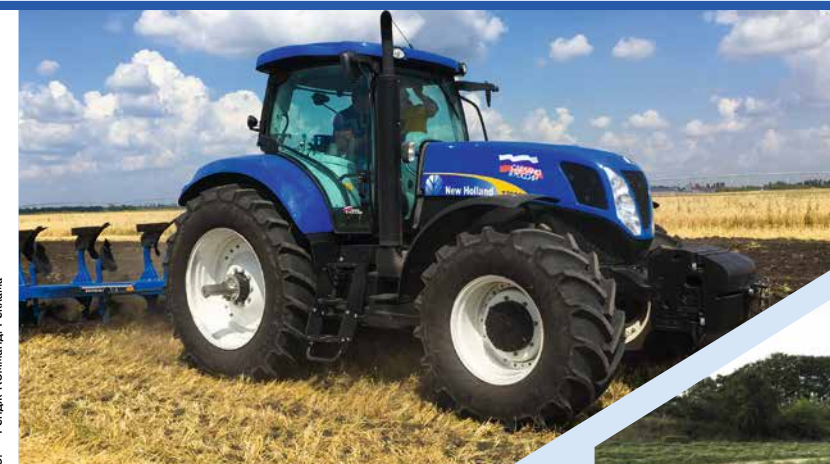
NEW HOLLAND T7060 (Англия /Россия) Мощность 213 – 242 л.с. Трансмиссия Full Power Shift 18x6 Гидросистема – 120 л/мин. Мощность на BOM – 218 л.с.
