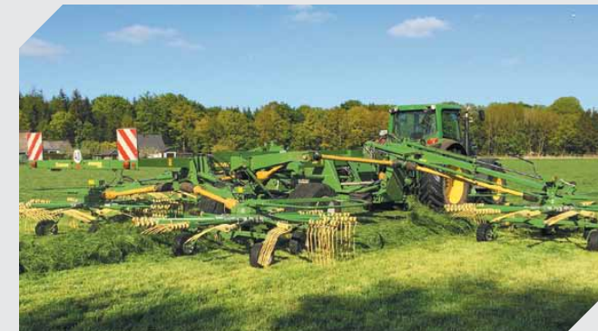
Валкователь прицепной четырехроторный с центральной укладкой валька Swadro 1400 Рабочая ширина захвата — 11-13,5 м
