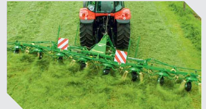
Ворошильщик роторный для трехточечной навески KW 7.82/6x7 Рабочая ширина захвата — 7800 мм
