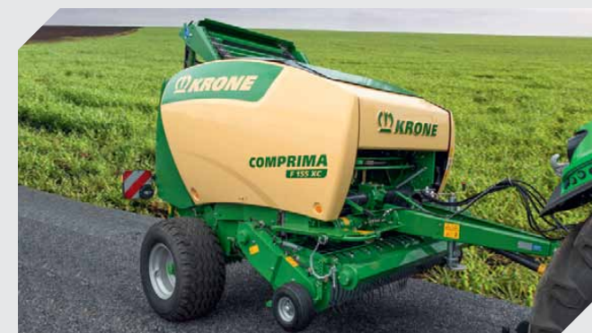
Пресс-подборщик рулонный с полу-вариабельной пресс-камерой Comprima F 155 Размер рулонов — 1,25-1,5 x 1,2 мм
