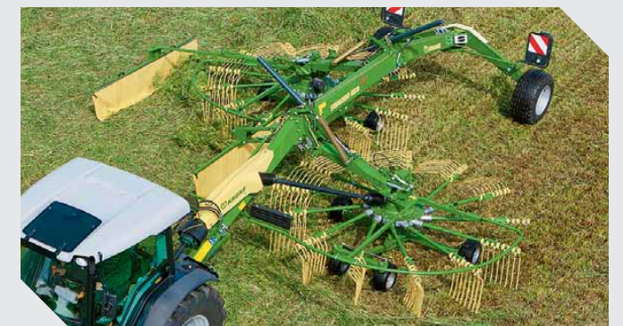
Валкователь прицепной двухроторный, с укладкой валька на сторону Swadro TS 620 Рабочая ширина захвата — 6,2 м
