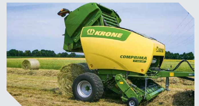
Пресс-подборщик рулонный с константной камерой Comprima F 125 Размер рулонов — 1,25 x 1,2 мм
