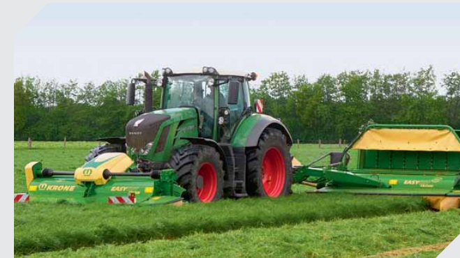
Комбинация косилок EasyCut B 870 CV Collect и EasyCut F 320 CV Ширина захвата – 8,7 м
